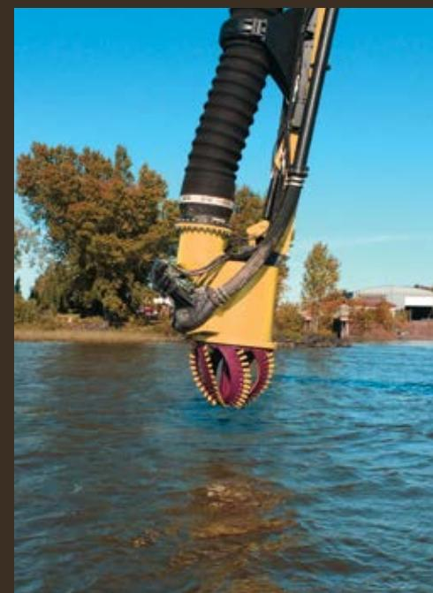
Amphibex 1200P répond à vos besoins de performance en volume les plus exigeants. La capacité de dragage se situe de 42 000 à 44 000 GPM. Dragage (sédiments contaminés, boue ou sable); installation de pipelines; pose de câbles; enfonçage de pieux; contrôle de plantes aquatiques.
