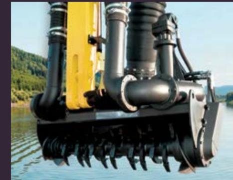
*Amphibex 850P responde a las necesidades de producción más exigentes en volumen. La capacidad de dragado es entre 18000 y 20000 GPM. Dragado (sedimentos contaminados, lodo o arena); instalación de tuberías; colocación y sumersión de cables submarinos; estampado de estacas; o control de plantas acuáticas;*
